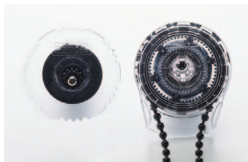
Embrayage démultiplié à chaînette avec fin de course basse, rapport 2,5 : 1
